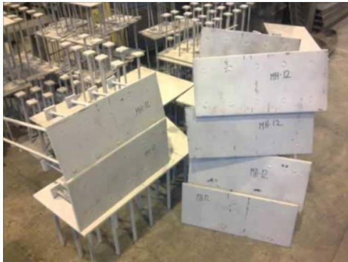
**Закладные детали** — металлические элементы (из круглой, полосовой, уголковой стали), применяемые в конструкции до бетонирования для соединений сваркой сборных и сборно-монолитных железобетонных конструкций различной сложности.
